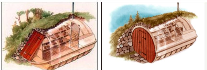
Fertig eingerichtetes Modul mit heller Innenauskleidung. Türen und Regale sind speziell beschichtet aus hygienischem und pflegeleichtem Obermaterial. Fußbodenroste sind aus druckimprägniertem Holz als Zubehör wählbar. Wir empfehlen während der Lagerung ein Hygrometer/Thermometer zu installieren damit das Klima kontrolliert werden kann. Ideal sind etwa 75-80% Luftfeuchtigkeit.
